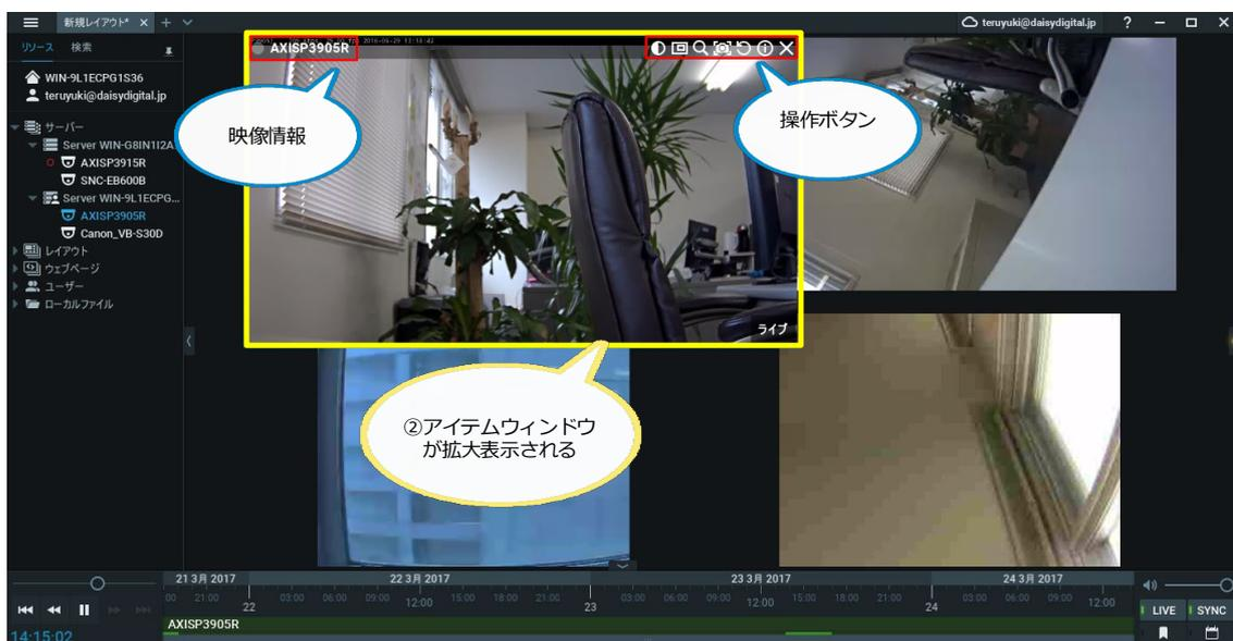
拡大されたアイテムウィンドウ上部のヘッダー部分には「映像情報」と「操作ボタン」が表示されます。次ページにその詳細を示します。
